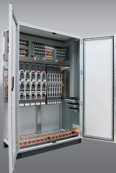
Konfigurationsbeispiel: Lastschaltleistenfeld Individueller Innenausbau mit Lastschaltleisten z.B. ABB NH01-03, Kabelanschluss von unten, 3-polige Strommessung
